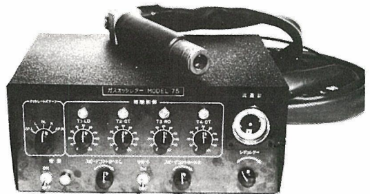
写真 パルス状のガス流を周期的に発生できる噴流ガス制御装置とアーク制御ノズルを内蔵した溶接トーチ
