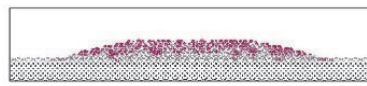
Si(001)表面上のGeクラスター(23,737原子)におけるFermiレベル近傍での電子分布
