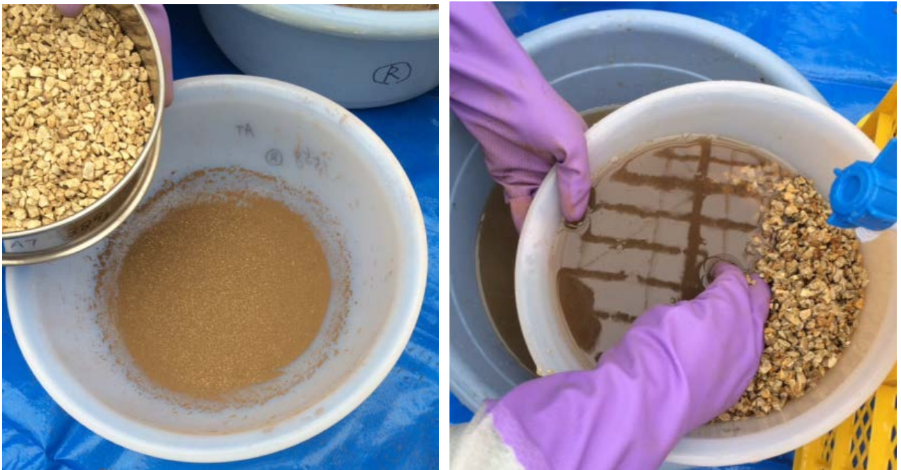
図 6.5.7 篩（左）と洗浄（右）により回収された細粒粘土粒子とその懸濁液
