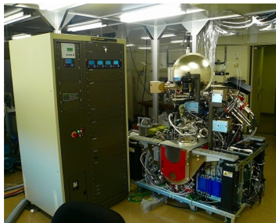
図 3.1.4. 高分解能飛行時間型 2 次イオン質量分析装置 (TOF-SIMS) の外観。
