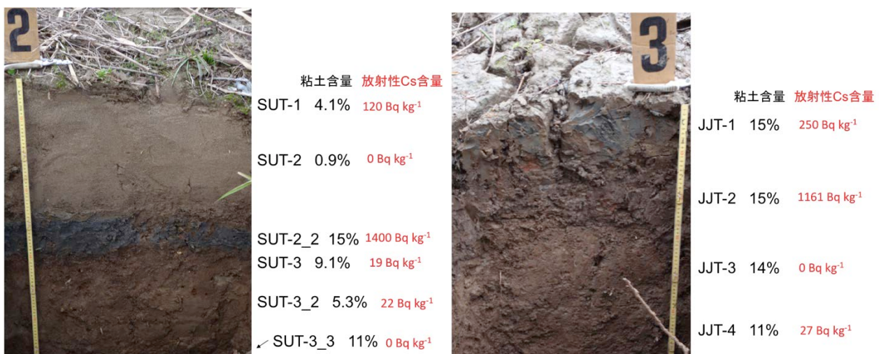
図 6.1.5 SUT (左) と JJT (右) の粘土含量と放射性 Cs 含量の垂直分布.
