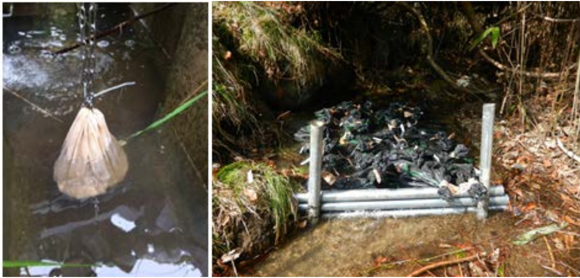
図 6.5.6 溪流に設置した焼成珪藻土（左図：飯舘村、右図：田村市）
