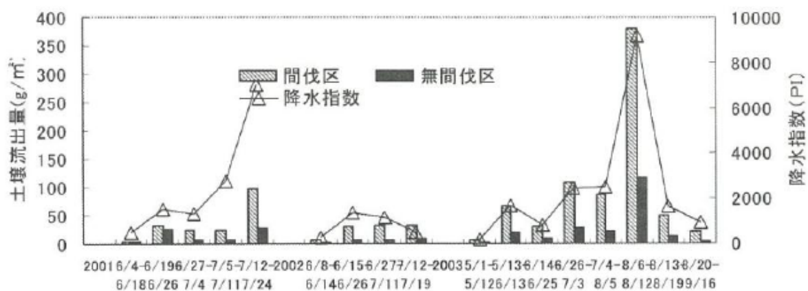
間伐区と無間伐区の土砂流出量の比較（ヒノキ林 定性間伐）
