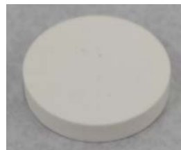
図 4.3.9 1200℃ で焼結した複合体 30 % 含有焼結体
