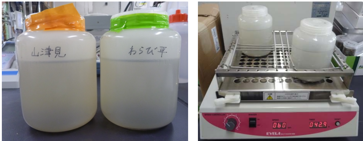
図 6.4.21 試験条件を設定した遠心分離用容器（左）と振とう中（右）の外観
