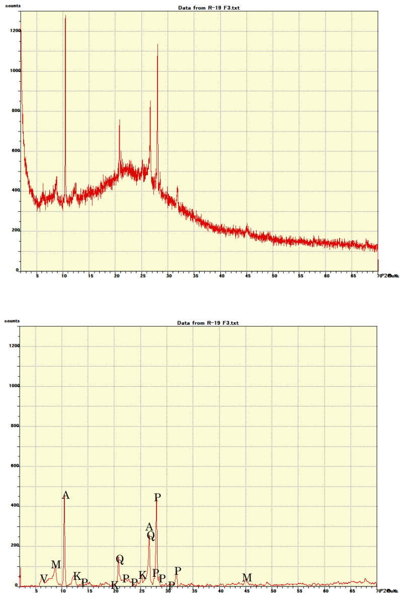
図 6.3.10 R19-F3 試料のパウダーオリエンテーション法によって測定された XRD パターン（上）とバックグラウンド処理を行って各ピークに対してアサイメントした結果（下） 凡例は A：角閃石、V：バーミキュライト、M：雲母、P：斜長石、Q：石英、K：カオリナイト
