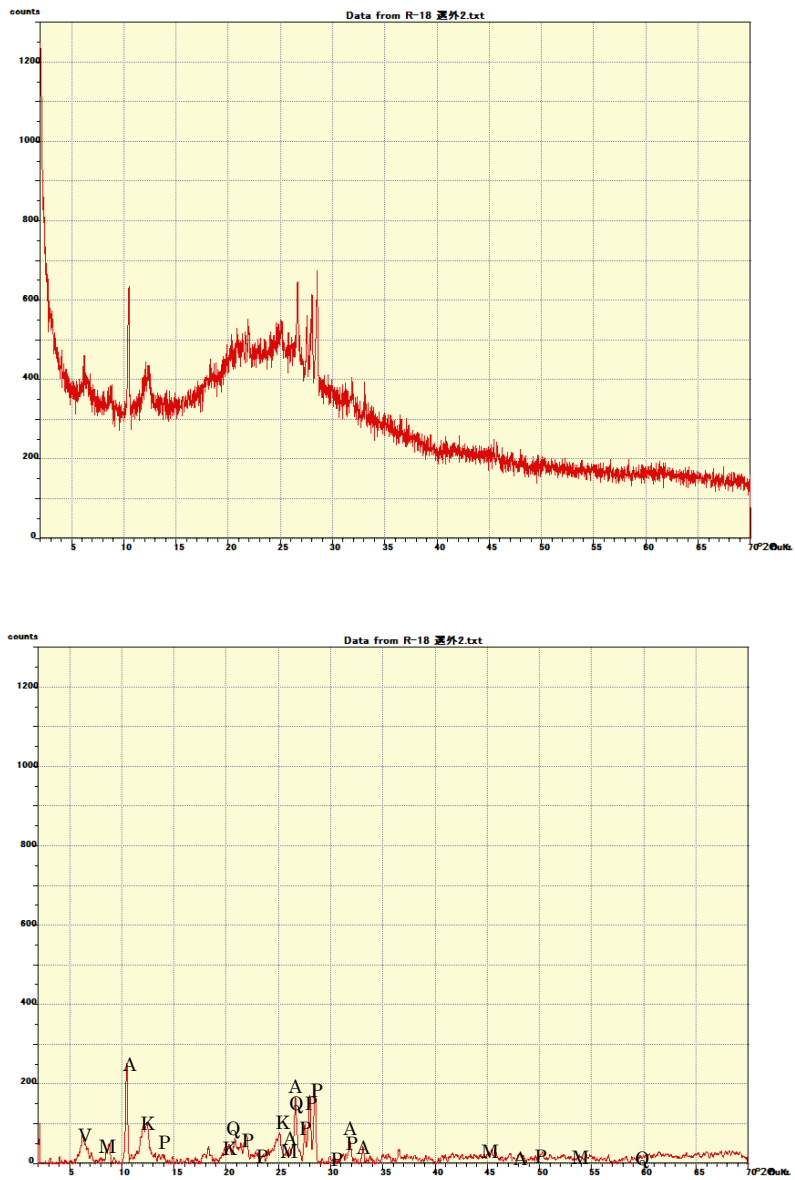
図 6.3.9 R18-F4 試料の粉末オリエンテーション法によって測定された XRD パターン（上）とバックグラウンド処理を行って各ピークに対してアサイメントした結果（下） 凡例は A：角閃石、V：バーミキュライト、M：雲母、P：斜長石、Q：石英、K：カオリナイト
