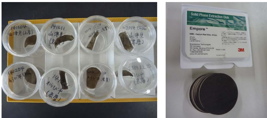
図 6.4.23 微粒子の残留するメンブレンフィルター（左）とラドディスク（右）
