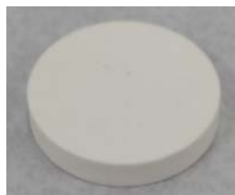
図 4.2.19 1200°C で焼結した複合体 30 % 含有焼結体
