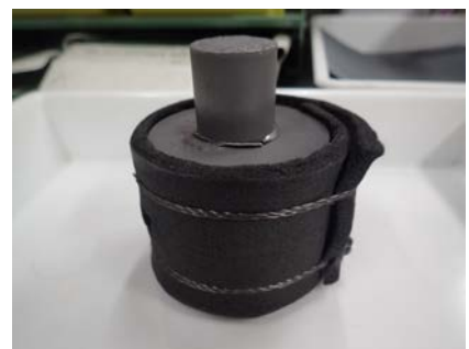
図 4.5.2 試料充填用のグラファイト製モールド
