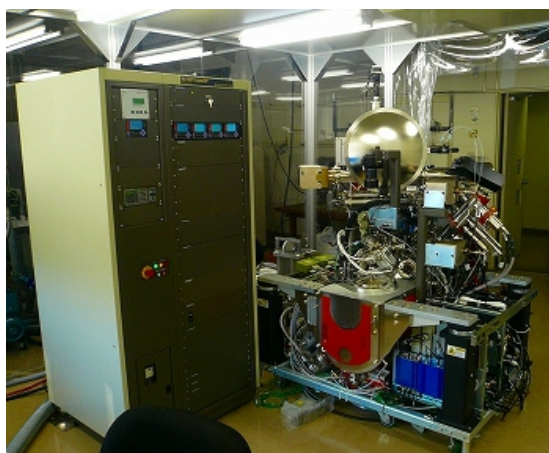
図 3.1.6. 高分解能飛行時間型2次イオン質量分析装置(TOF-SIMS)の外観。
