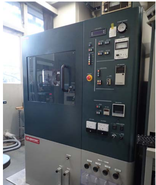
図 4.5.1 放電プラズマ焼結機
