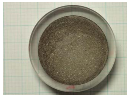
図 4.5.5 SEM 観察用研磨片の一例
