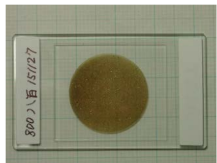
図 4.5.4 光学顕微鏡観察用薄片の一例
