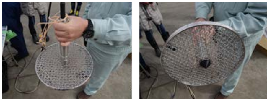
図 5.2.3 土中挿入方式フィールドサーベイメーター（株式会社ジオファイブ製）写真
