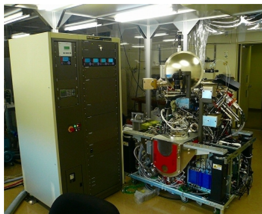
図 3.1.4. 高分解能飛行時間型質量分析装置 (TOF-SIMS) の外観。
