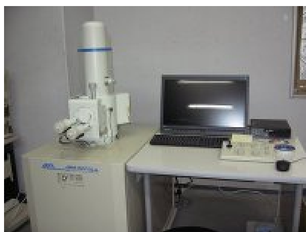
図 3.1.3 エネルギー分散型 X 線分光器付属走査電子顕微鏡 (SEM-EDS)
