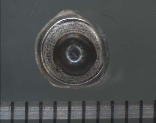
図 6.2.8 1300°C の加熱によるバーミキュライトの減容化。白金パンの中の黒い物質が加熱後の生成物(残渣)。
