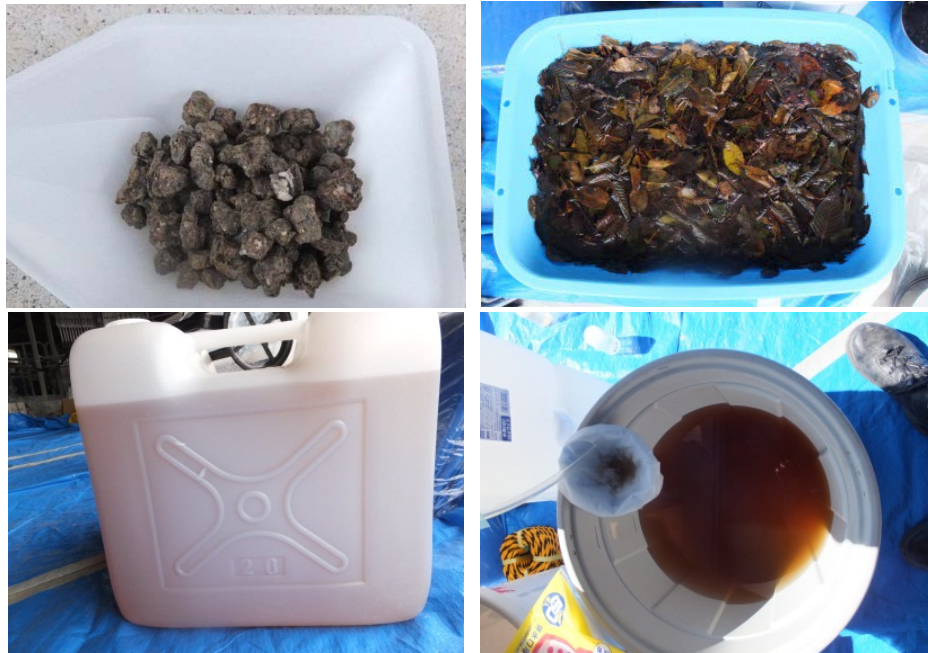
写真 6.6.2 手選別後のバーミキュライト原鉱(左上), 植物体の浸漬中(右上), 浸出液(左下), 試験後の材料回収濾過(右下)の様子
