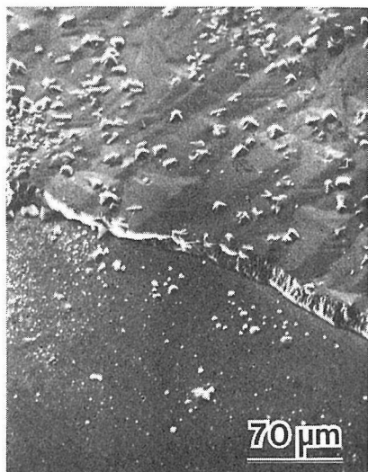
図 4.30 {100}面上のダイヤモンド析出層と欠落部のSEM像
