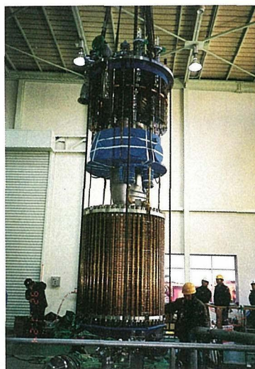
写真 20 T 大口径超電導マグネットの外観
