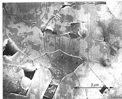
図4 プラズマ焼結した緻密炭化けい素の微構造
