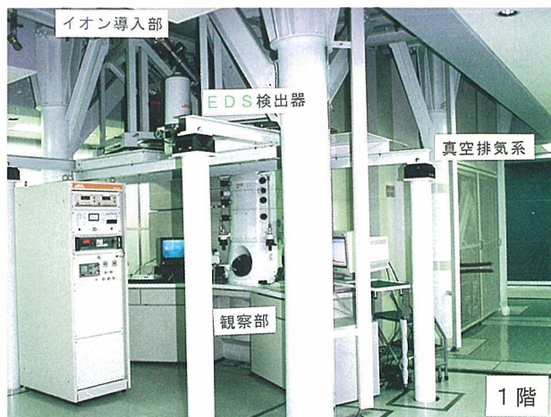
写真 透過型電子顕微鏡法とイオン照射法を組み合わせた複合システム
