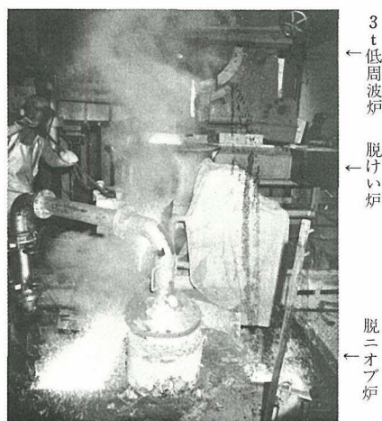
写真 操業中の連続選択酸化実験装置
