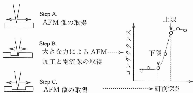
図42 AFM/STM による酸化膜の膜厚測定手順
