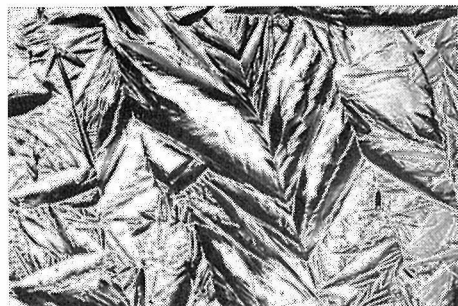
写真 Fe-32% Ni合金のマルテンサイト組織（ -196^{\circ}\text{C} に急冷） \times 200
