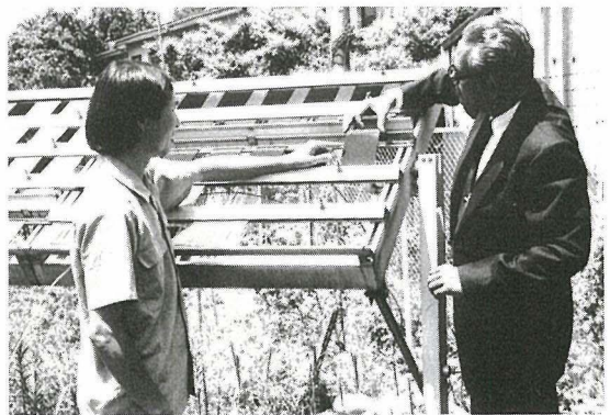
写真 インド製標準照合試験片の暴露状況
