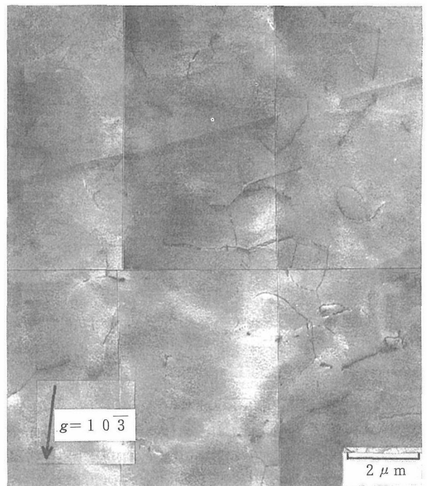
図16 1673Kで<100>方位に3.8%圧縮変形された MoSi 2 の透過電顕で観察された {110} 面上の積層欠陥。
