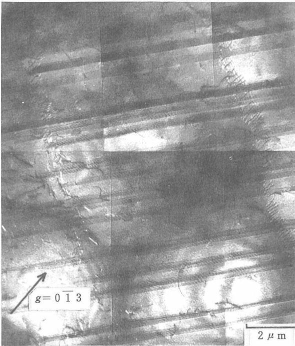
図17 1673Kで<001>方位に1.6%圧縮変形されたWSi 2 の透過電顕で観察された{110}面上の積層欠陥。
