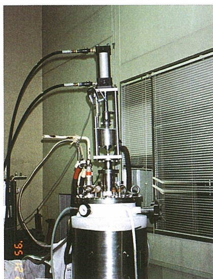
写真 強磁場中での引張試験用装置
