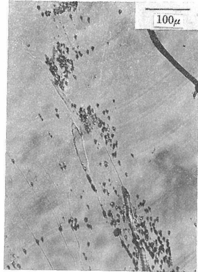
図13 中間部での欠陥の導入(結晶は上方に成長)
