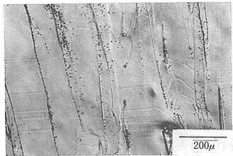
図10 育成速度 2 mm/h にした時の固液界面の例 (結晶は上方に成長)
