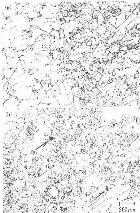
写真 2 溶接・熱処理材の光顕組織
