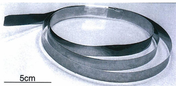
写真1 冷間圧延した厚さ90ミクロンの \text{Ni}_3\text{Al} 箔。箔の表面性状はよく、滑らかで美しい
