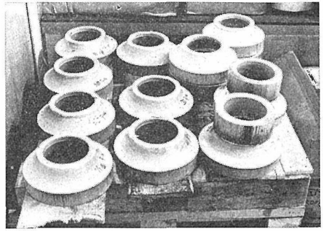
図65 FB120 用ガスケット (成形品)
