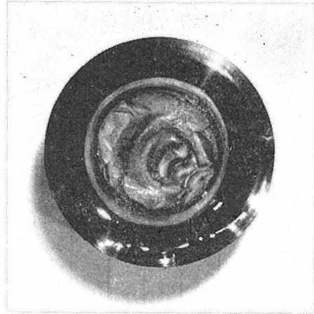
図55 FB25 アンビルの破壊例
