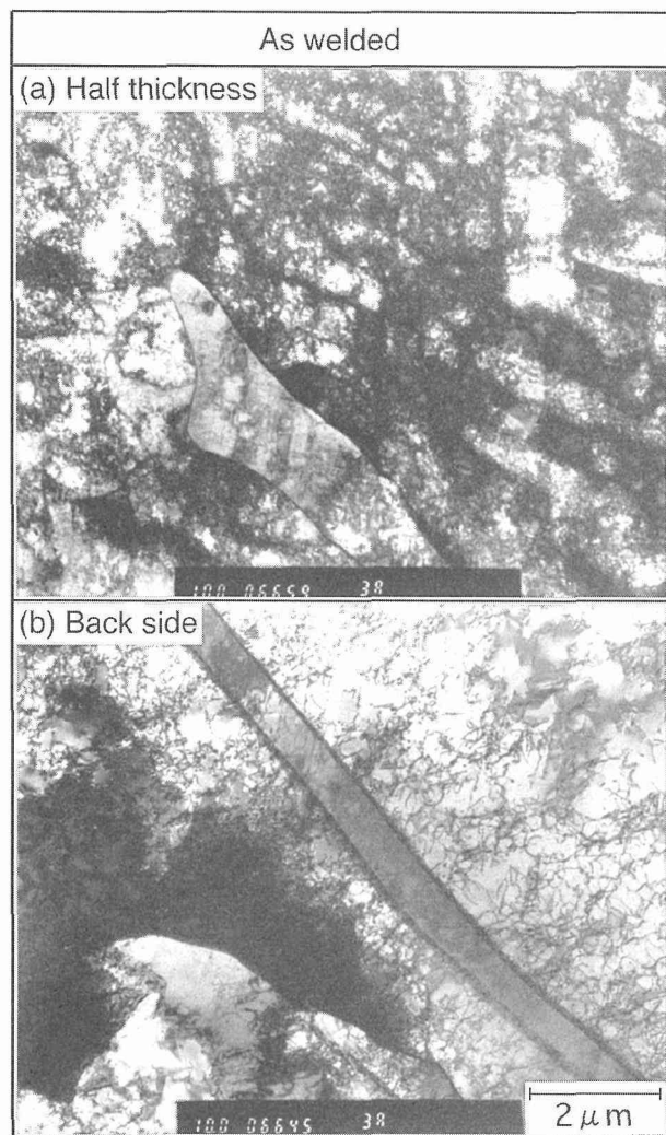
図 4-5 316FR 溶接金属部の透過電子顕微鏡組織
