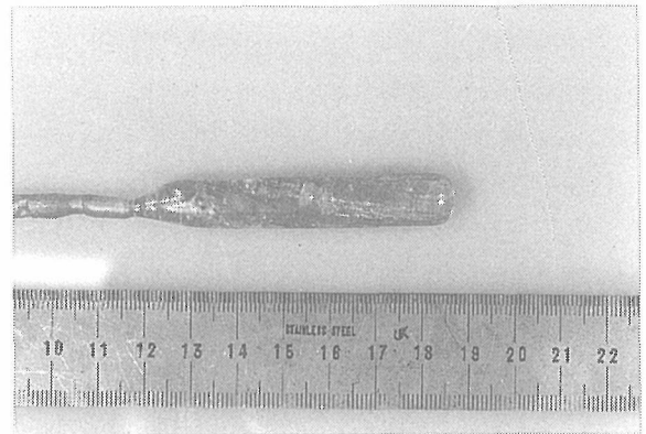
図3.8 DyAlO 3 外観写真(クラックが生じたもの)
