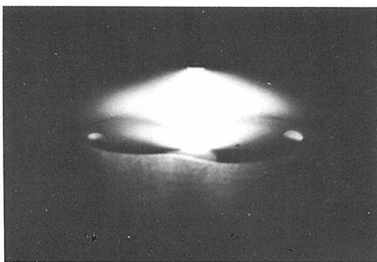
写真1 TIGアークでの陽極点分布制御による溶融池の表面の状態
