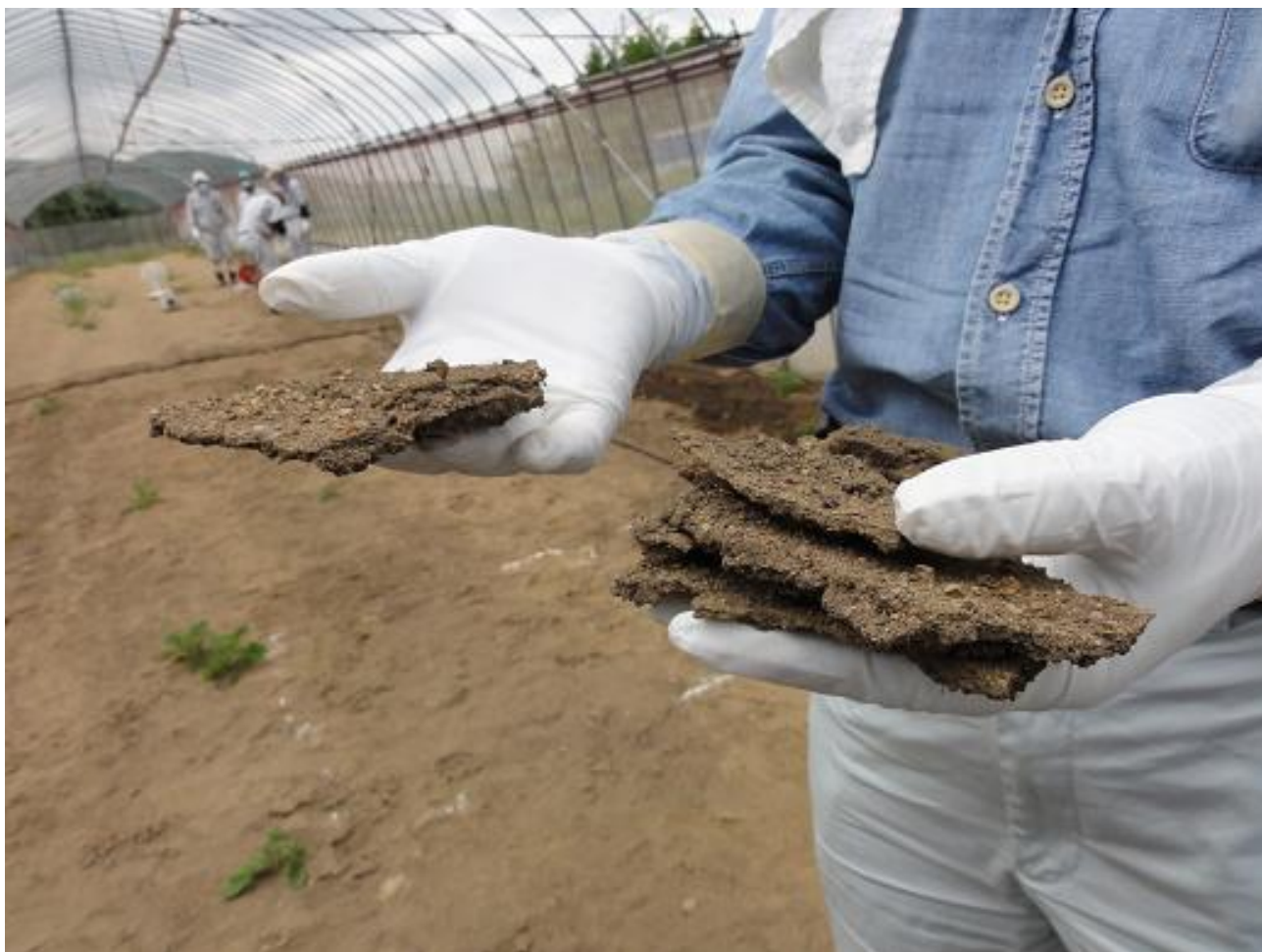
図 3.2.4 天然ポリイオンで表面だけ固化された土壌の写真
