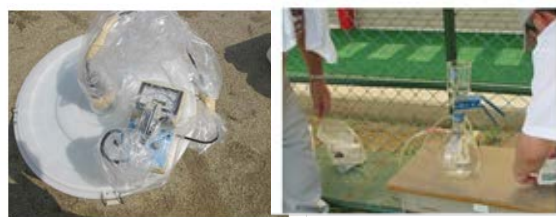
ポリバケツとポリ袋に包んだサーベイメータ
