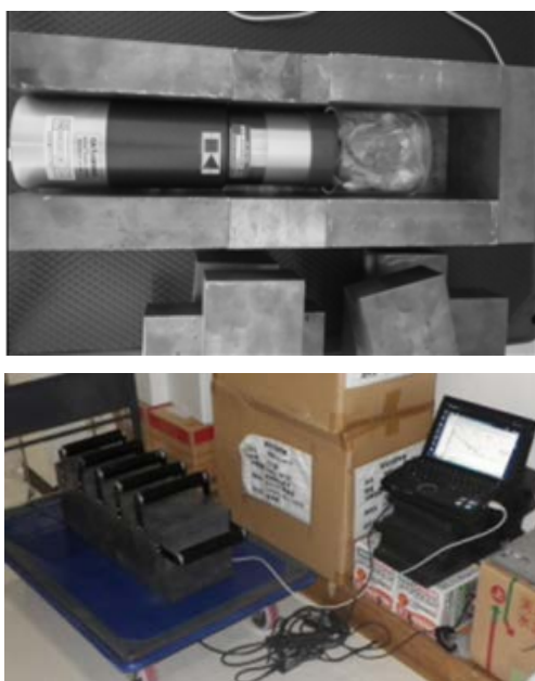
図 4.3.2 \gamma 線スペクトロメータ計測部と鉛遮蔽（上）及び現場測定の様子（下）
