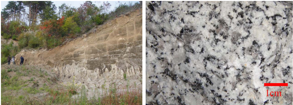
図4.3 飯館村における花崗岩の風化が観察される露頭と新鮮な花崗岩.
