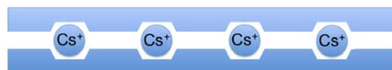
図 3. 6. 7 粘土鉱物におけるセシウムイオンの不可逆的な吸着固定
