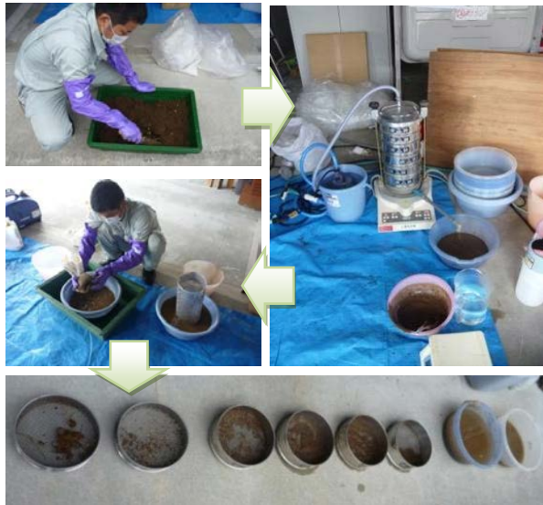
図 4.3.10 土壌分級洗浄試験手順 (左上：土壌試料の攪拌・均一化， 右上：電磁式実験用ふるい振とう機， 左中：篩い残りの手篩いと濁水の固液分離， 下：分級後の各粒度画分の試料)
