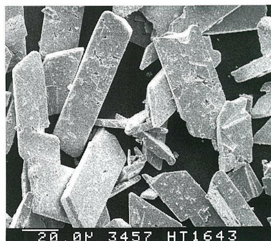
図1 Bi 5 O 7 NO 3 のSEMによる結晶写真（無機材研 堀正幸氏により撮影された）
