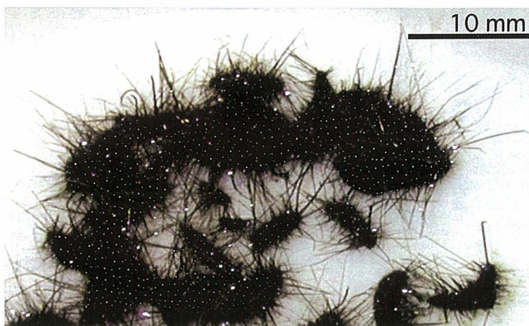
図1 ビスマス系高温超伝導ヒゲ状結晶の写真。ウニのトゲトゲのように見えるのがヒゲ状結晶。
