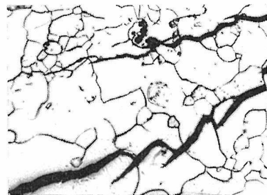
(b) 破断後のクラックの状態
