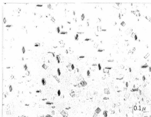
写真 窒化した Fe-0.5% Ti 合金中の窒化物 ( \times 21,500 )
