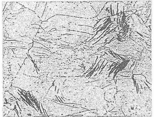
写真5 Ti-3Al-8V-6Cr-4Mo-4Zr 合金の疲労破断後の光学顕微鏡組織
