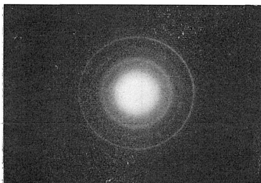
図-3 50°Cで予備加熱されたマキナバイト(表面を非晶性硫黄で覆われている)の電子回折像
