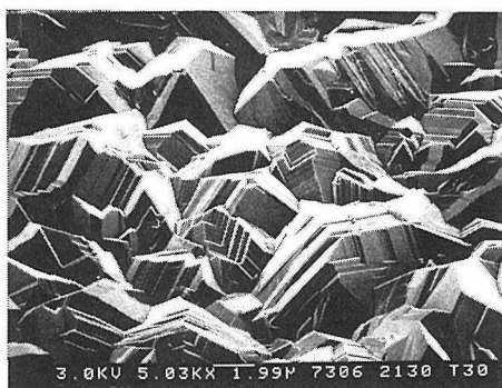
図2 メタン濃度0.3%でシリコン基板上に成長した多結晶膜表面のSEM像
