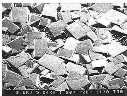
図3 メタン濃度3%でシリコン基板上に成長した(100)配向膜表面のSEM像
