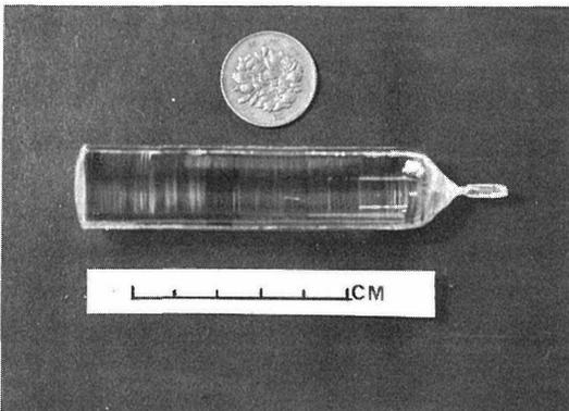
図2 ニオブ酸リチウム ( $\text{LiNbO}_3$ ) の単結晶
