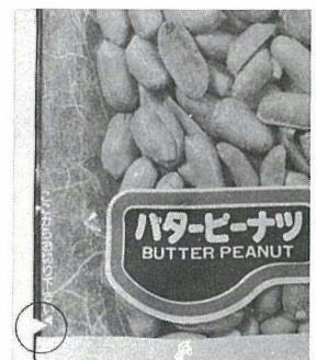
写真 丈夫な袋も小さな切込みがあると容易に破れる。鉄鋼材料も、小さな欠陥から大きな破壊が発生することがある。
