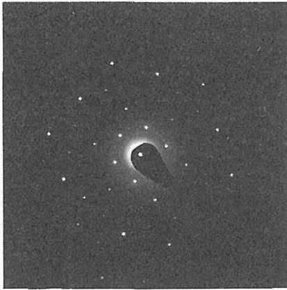
図2.14“12Å相”の制限視野回折像
