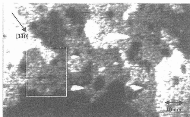
図13 基板温度440°C、As雰囲気中( \text{As}_4: 2 \times 10^{-6} torr)でのその場STM観察結果。
