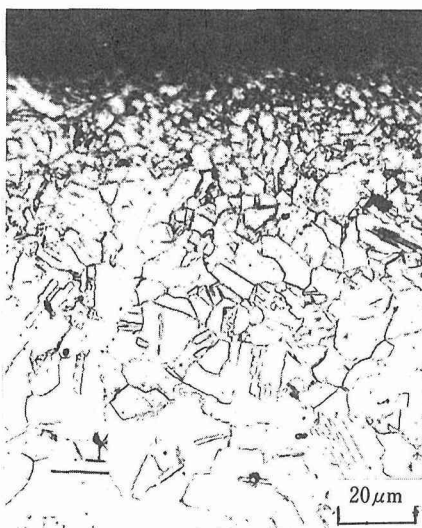
写真5 ショットピーニング後窒素中固溶化処理により得られた表面細粒層
