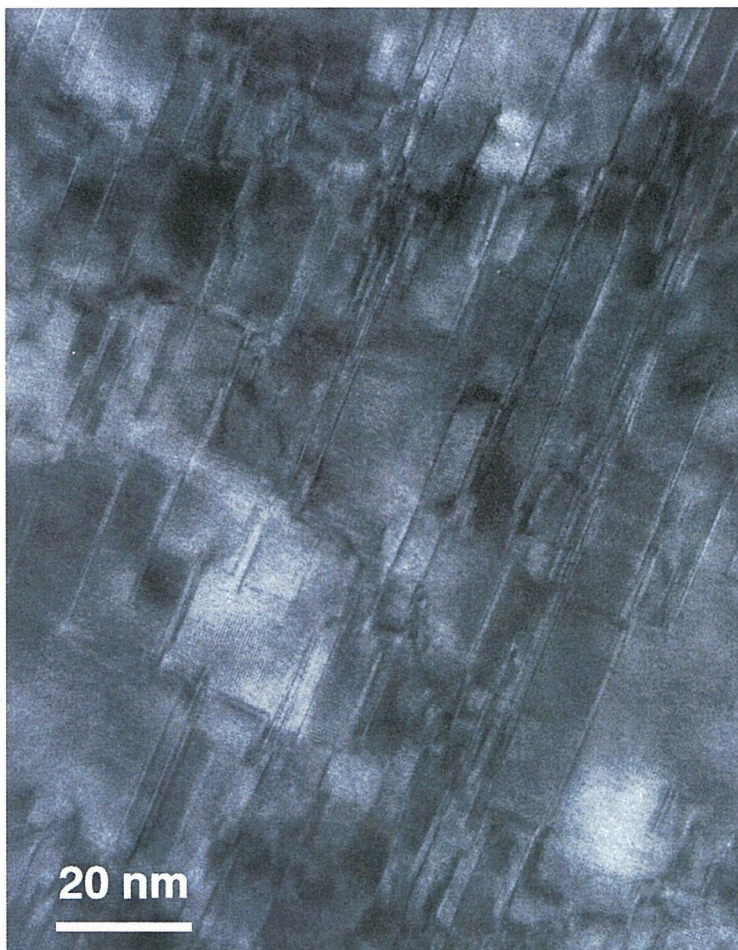
写真1 急熱急冷・変態法 Nb_3Al 中に生成している多量の積層欠陥。
