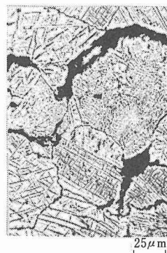
写真 2 F 1 合金のクリープ破断 (1000℃, 615h) 後の組織
