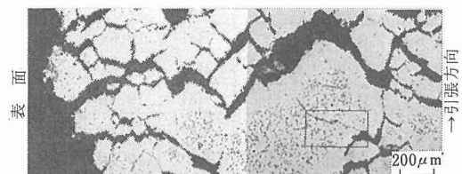
写真8 No. 0合金(Ni-20Cr)を大气中で1874時間クリープ後中断した試料の表面近傍の顕微鏡組織
