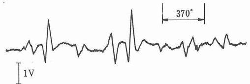
図10 試験中におけるEC信号例
