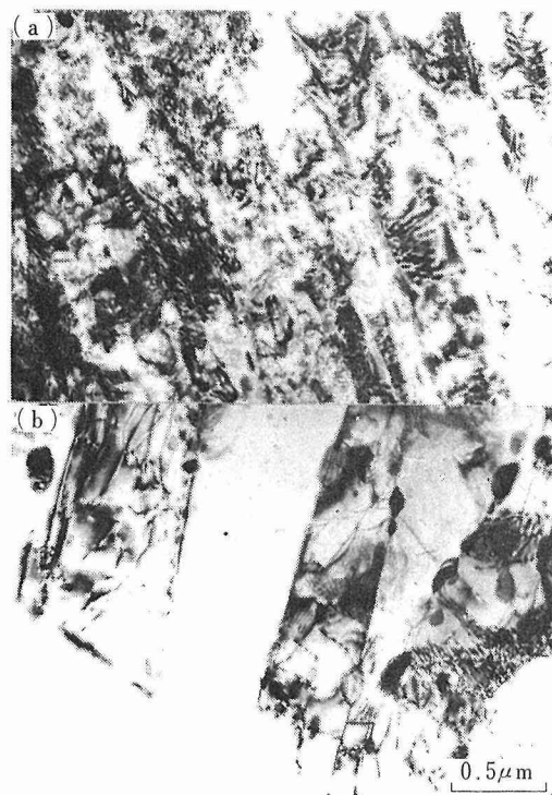
写真13 Mg-1.3wt\% Ce 合金の溶体化処理材を室温で30%圧延した後、250°C(a)および350°C(b)でそれぞれ1 h 焼なましを行った後の薄膜透過電顕観察組織。(a) 圧縮変形帯の領域における転位の回復の状態。(b) (1012)双晶内の転位網と再結晶粒が一部観察される状態。
