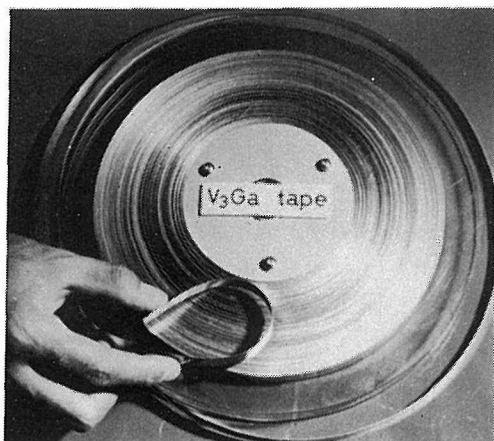
写真2 V 3 Ga テープ (幅10mm, 厚さ0.13mm)
