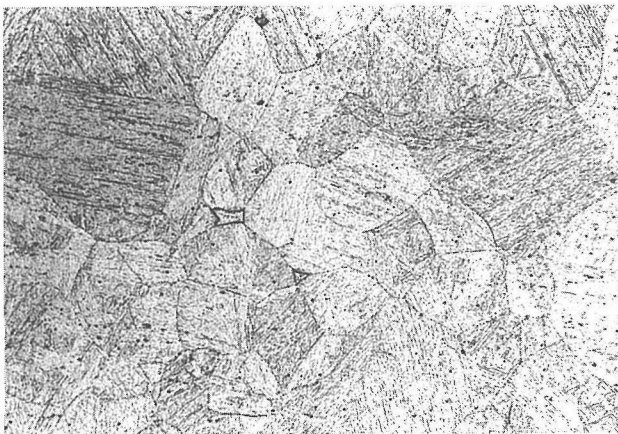
図11 0.0025 wt%B合金の粒界及びフェライト内に見られるborocarbide析出物。
