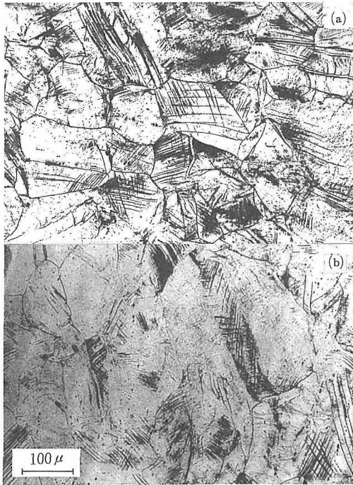
写真 600°C × 2 h の SR 処理材のマイクロ組織 (a) HD-2 鋼, (b) HD-3 鋼
