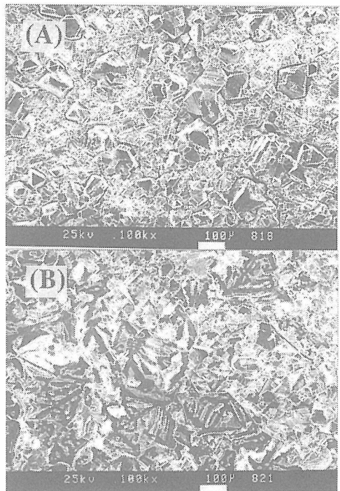
図3.9 7.7GPa、2200°C、10分間の条件で合成したダイヤモンドのSEM像（熱水処理） (A) リンに近い部分のダイヤモンド、 (B) Moカプセルに近い部分のダイヤモンド
