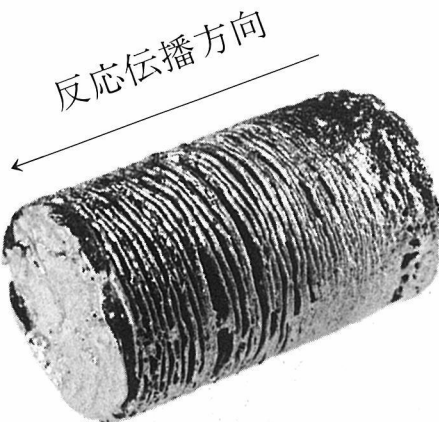
写真 自己燃焼法で合成した水素貯蔵合金ZrNi（直径17mm，長さ30mm）
