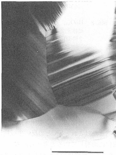
図6.9 SiC焼結体のTEM写真 (HoO 1.5 ; 0.1モル%, C ; 3モル%, 図中の棒線は1μm)
