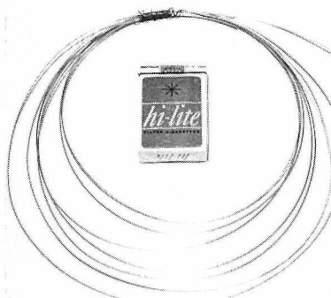
Agシース法によるYBa 2 Cu 3 O y 超電導線材
