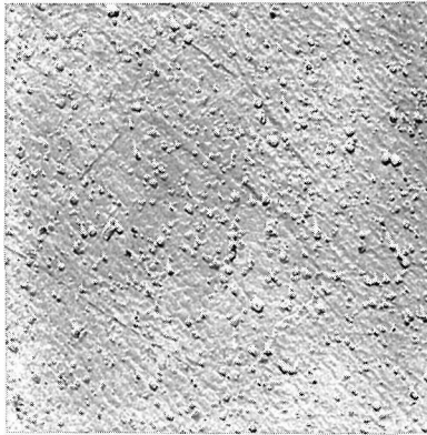
写真 分散強化型合金の押出材をさらに 10% 冷間加工した試料の電子顕微鏡組織 (Ni-0.6%Al 2 O 3 合金) (×2000)
