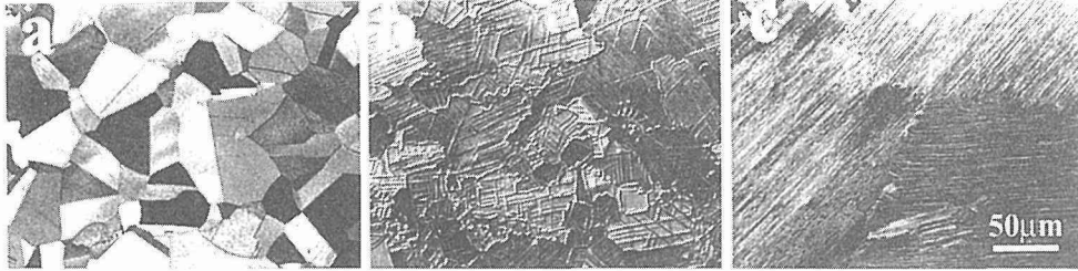
図 1 Ti-49Al のマイクロ組織：熱処理温度 (a) 1423 K, (b) 1573 K and c) 1703 K
