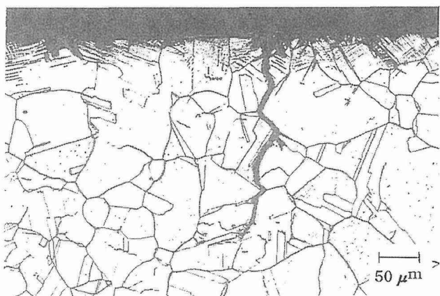
(c) \Delta \epsilon_t = 1.20\% の断面き裂の様相
