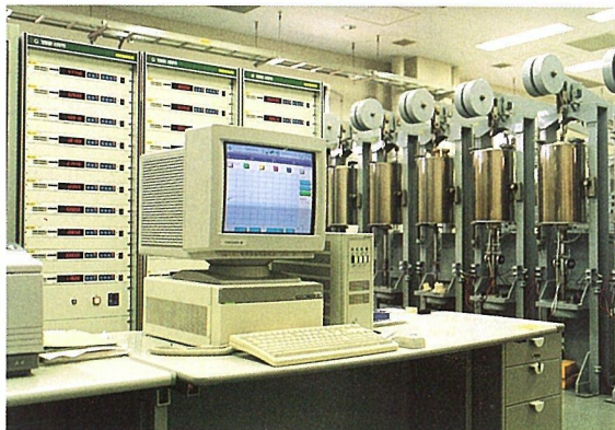
写真1 クリープ試験温度監視装置
