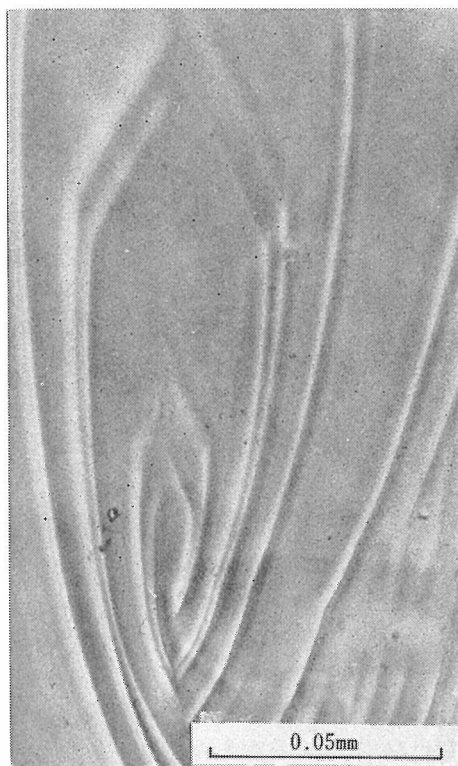
図11 PbF 2 フラックスから育成した ZrO 2 単結晶の {100} 表面上の渦巻成長模様。結晶自体の単斜対称と成長の異方性を特徴的に示す
