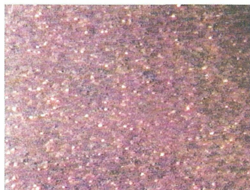
写真 1 磁界ゼロにおける磁性流体微粒子の様相
