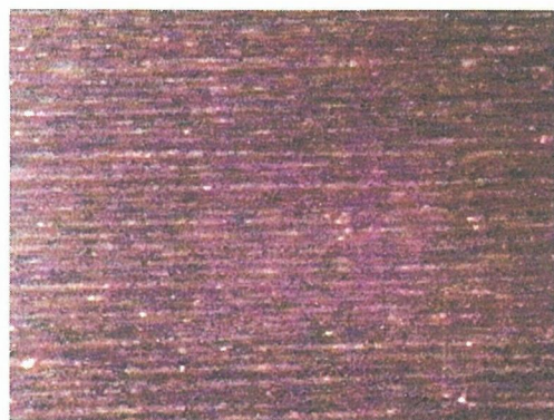
写真 2 磁界 1000 Oe における磁性流体微粒子の様相
